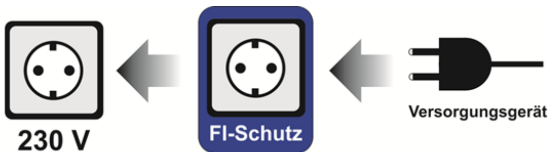
Grafik: Reihenfolge beachten: FI-Personenschutz-Zwischenstecker in die Netzsteckdose. Versorgungsgerät in den Anschluss des FI-Personenschutz-Zwischensteckers.
